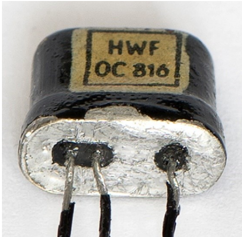
Druckglasdurchführung eines Anfangs der 1960er Jahre hergestellten Transistors
