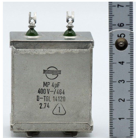
Metallpapierkondensator mit angepassten Glasdurchführungen
