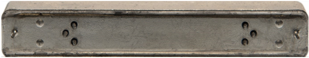
Glasdurchführungen an der Unterseite eines magnetomechanischen Filters
