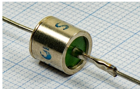
Gleichrichterdiode mit gefärbter Druckglasdurchführung
